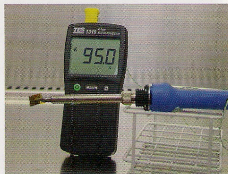
Afbeelding 1. Voor het maken van de brandwond wordt een soldeerbout gebruikt met een koperen plaatje. De temperatuur van dit plaatje kan worden afgelezen met behulp van een thermometer.
